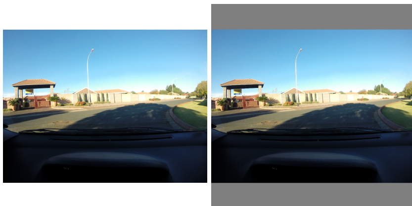
Figura 4: A la izquierda la imagen original redimensionada a tamaño 920x690 px (manteniendo la relación de aspecto 4:3). A la derecha la imagen redimensionada con el relleno para que tenga una relación de aspecto 1:1 (920x920 px)
