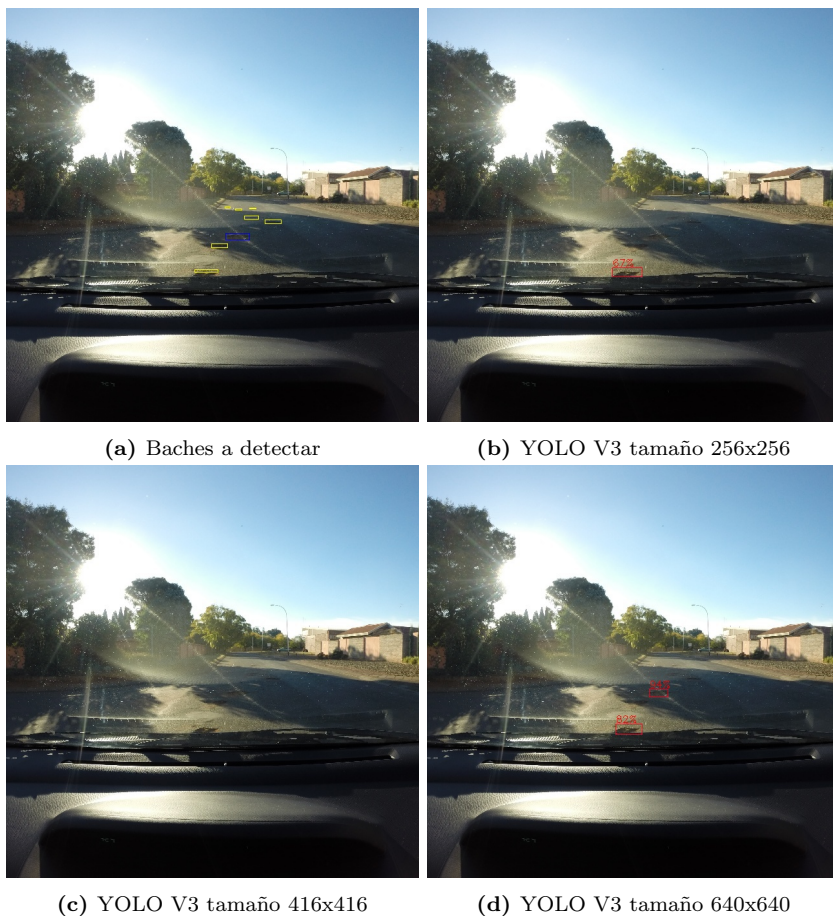
Figura 15: Ejemplo de predicción con modelos YOLO V3 de distintos tamaños. Arriba a la izquierda, la imagen con los baches a detectar en azul y en amarillo los baches que fueron descartados por el filtro. En el resto de las imágenes se pueden ver las predicciones realizadas en rojo.
