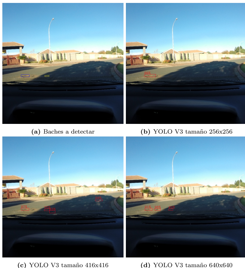
Figura 11: Ejemplo de predicción con modelos YOLO V3 de distintos tamaños. Arriba a la izquierda, la imagen con los baches a detectar en azul y en amarillo los baches que fueron descartados por el filtro. En el resto de las imágenes se pueden ver las predicciones realizadas en rojo.
