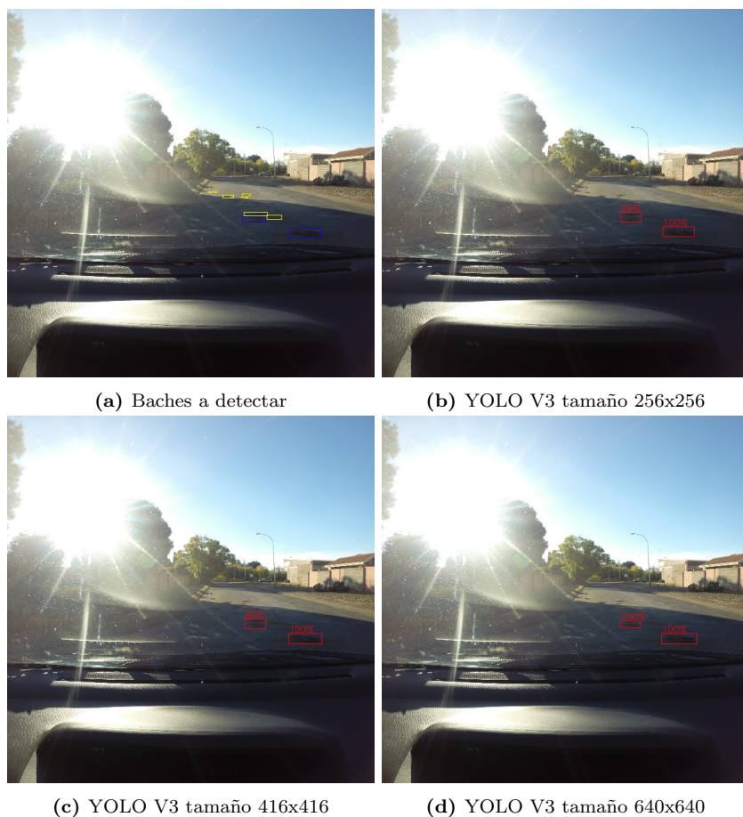
Figura 17: Ejemplo de predicción con modelos YOLO V3 de distintos tamaños. Arriba a la izquierda, la imagen con los baches a detectar en azul y en amarillo los baches que fueron descartados por el filtro. En el resto de las imágenes se pueden ver las predicciones realizadas en rojo.
